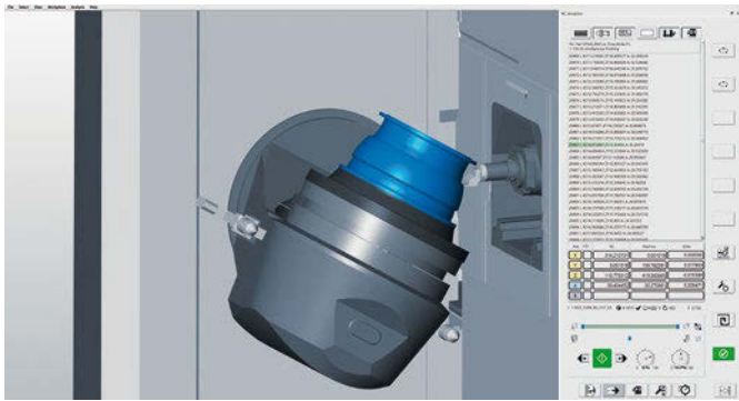
新增:在 hyperMILL SIMULATION Center 和虚拟机床中, 旋转的几何形状如此显示
