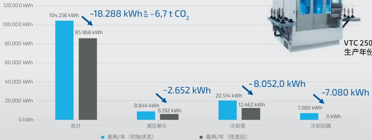
本示例以一台 2008 年生产的 VTC 250 轴类车床为例，该机床状况良好，无泄漏或类似缺陷。能量流图显示了机床不再符合最新技术水平的三个方面：液压装置、冷却剂泵和冷却装置。这三个单元都已更换。最终结果是，用户每年可节省约 18,000 千瓦时或
